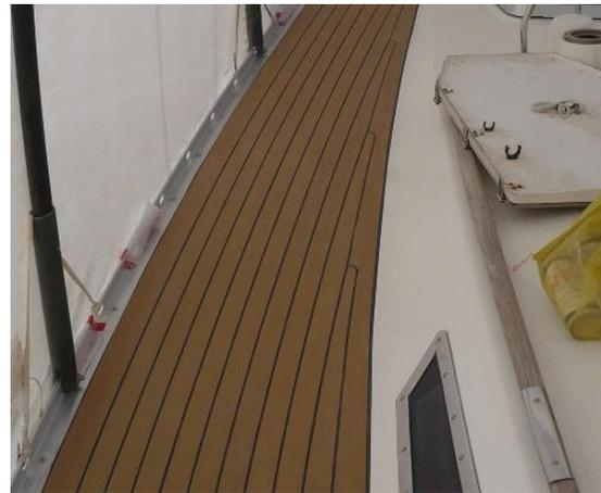
Fabrication et collage du passavant à partir du livet, la latte de bordure du roof est ajustée et collée, les joints de finition sont réalisés en dernier.
