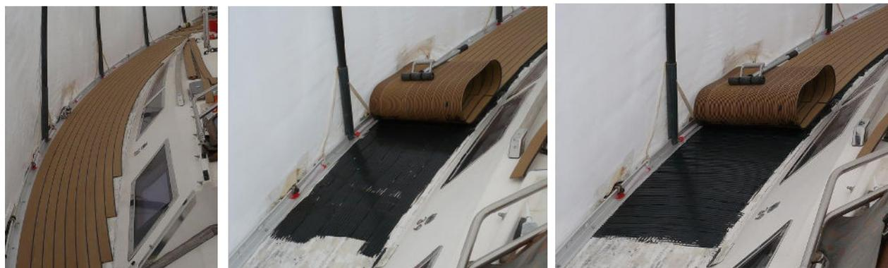
Passavant en place    on étale la colle dans le sens des rainures    puis on racle dans l'autre sens
